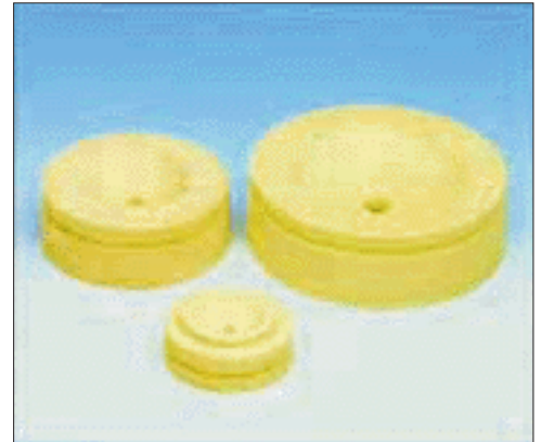
Regelscheiben ( k_{VS} -Werte variabel) Werkstoff: Alsint 99,7 Anforderungen: verschleißfest, hohe Präzision, chemisch resistent
