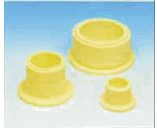
Einsätze für Reduzierstücke Werkstoff: Alsint 99,7 Anforderungen: verschleißfest, hohe Präzision, chemisch resistent
